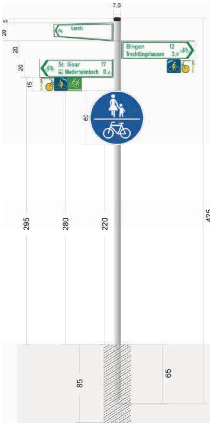
Bei neuen Pfosten wird in der Planungssoftware VP-Info die Pfostenlänge automatisch ermittelt. Neben dem vertikalen ist auch das horizontale Lichtraumprofil zu berücksichtigen. Zwischen der Außenkante des Schildes und dem Fahrbahnrand sollte innerorts ein Abstand von 50 cm bestehen, in Ausnahmefällen bei sehr beengten Verhältnissen reichen auch 30 cm. Außerorts (an klassifizierten Straßen) ist ein Abstand von mindestens 100 cm einzuhalten.
