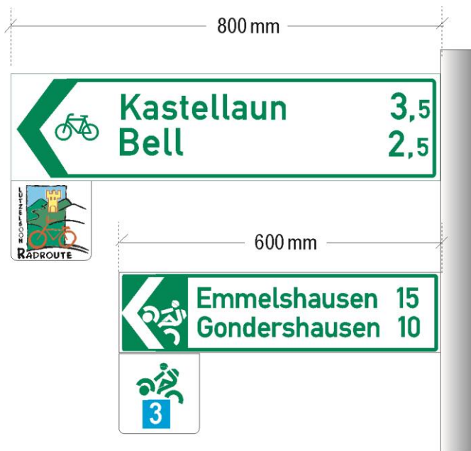
Abbildung P- 60; Parallelführung mit abweichenden Ziel- und/oder Kilometerangaben
