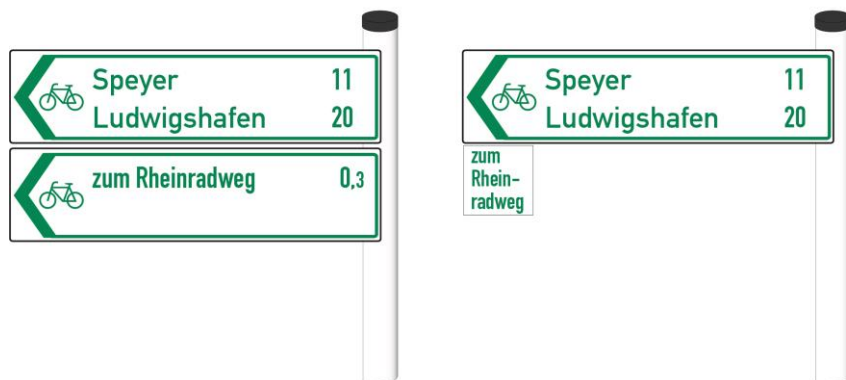
Abbildung P- 30: Wegweisung zu Radrouten - Beispiele
