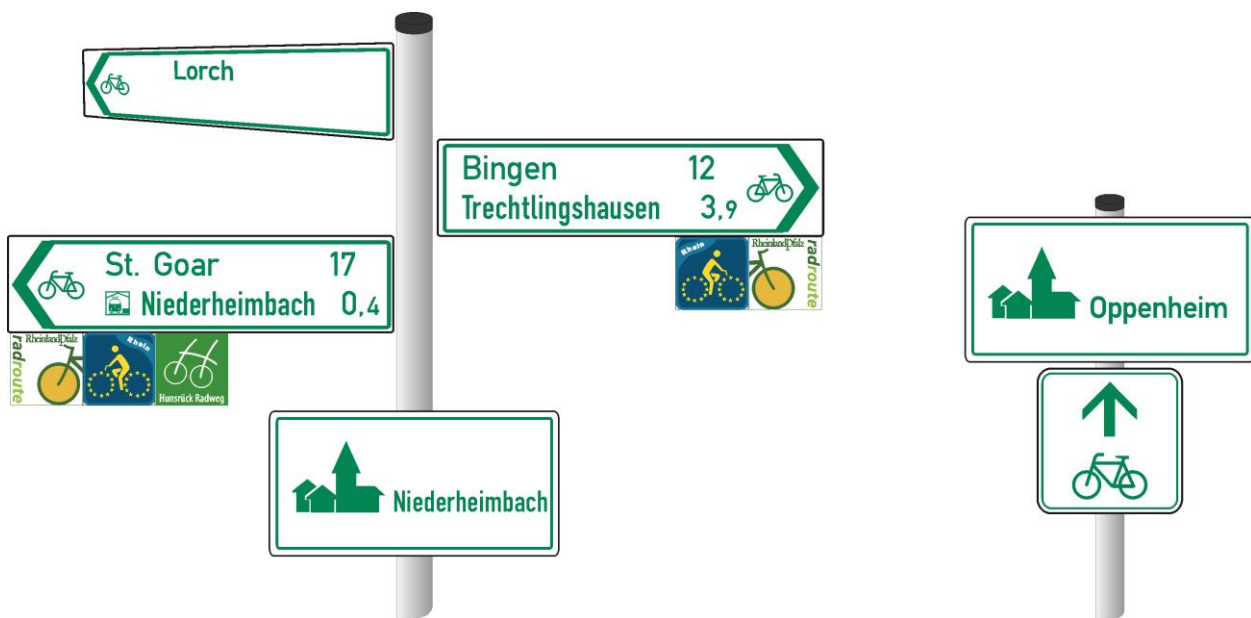
Abbildung P- 22: Montagefolge bei der Kombination von Ortseingangsschildern mit anderen HBR-Wegweisern
