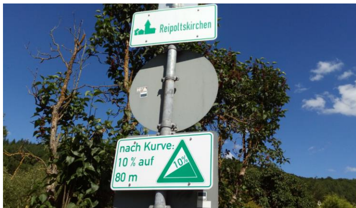
Abbildung P- 34: Beispiel für Ankündigung einer Steigung mit %- und Längenangabe
