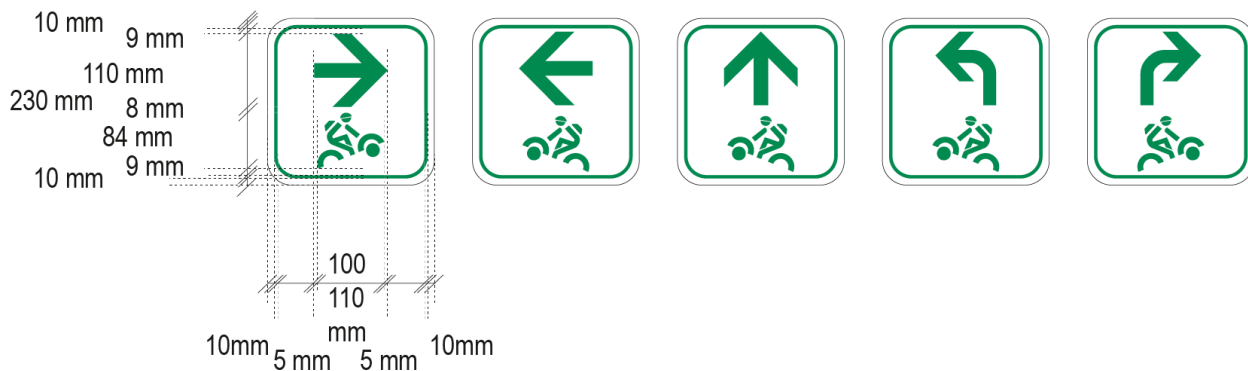
Abbildung P- 56: Maße der Zwischenwegweiser MTB
