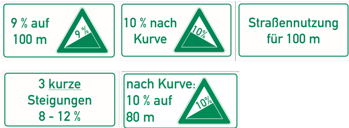
Abbildung P- 42: Mögliche Inhalte kleines Zusatzschild, Beispiele
