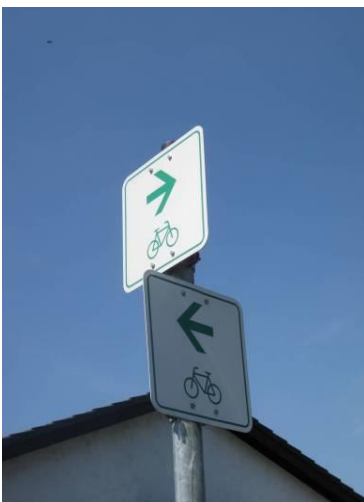
Zwischenwegweiser mit Fahrtrichtungswechsel am Pfosten mit 60 mm Durchmesser
