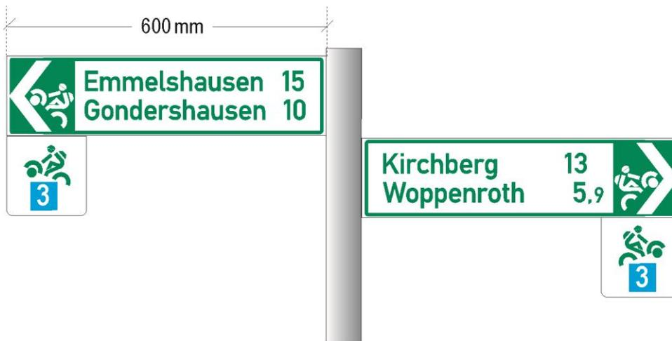
**Abbildung 32: Pfeilwegweiser MTB mit Zielangaben und Einschubplaketten**
